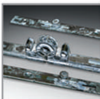
نمونه فلجه تولیدی پس از انجام تست Salt Spray
